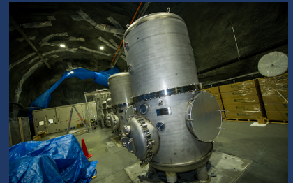
KAGRA入射光学系:レーザー光源からの光を3腕に導入する光学系を格納する真空タンク群。
