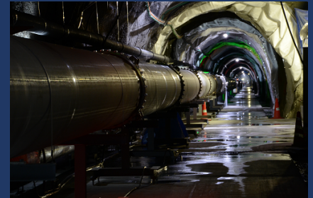
3km真空ダクト:長さ3km・直径80cmの超高真空ダクト中をレーザー光線が通ることで、重力波が検出される。
