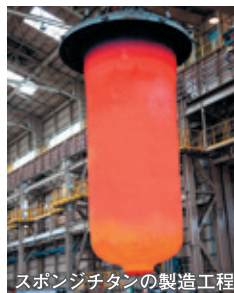
スポンジチタンの製造工程 写真提供： 株式会社大阪チタニウムテクノロジーズ
